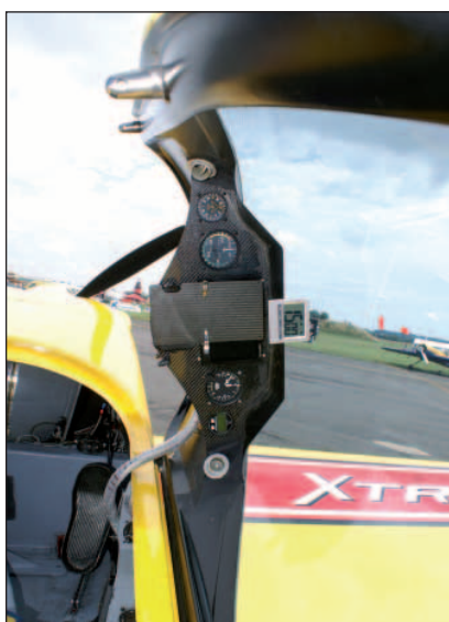
Strohá přístrojová deska se odklápí i s překrytem
