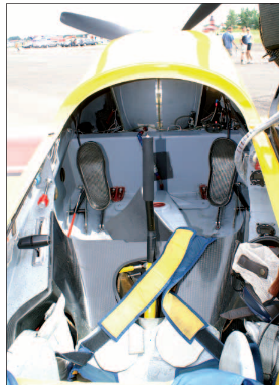
Prostor před nožním řízením lze využít k přepravě zavazadel. I s otevřeným překrytem lze bezpečně pojíždět (vlevo)
